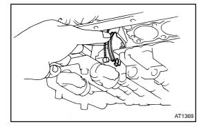
(d) Disconnect the throttle cable from the cam.
