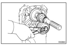
17. INSPECT COUNTER 5TH GEAR THRUST CLEAR-ANCE
