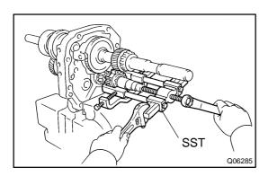
(d) Using SST, remove the No.3 clutch hub. SST 09950–40012
