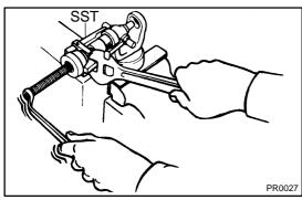
(d) Using SST, install new bearings on the spider. SST 09332–25010
