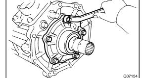
8. REMOVE FRONT BEARING RETAINER
